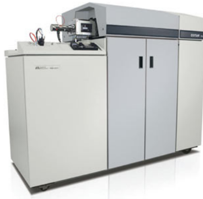
Joonis 2. ESI Q-TOF mass-spektromeeter QSTAR Elite (Applied Biosystems)
